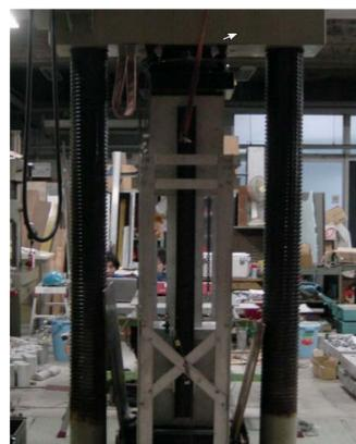
残存軸力を求めるため鉛直加力を行う
