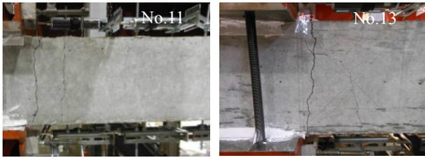
写真1 極稀地震相当加振後の損傷状況
