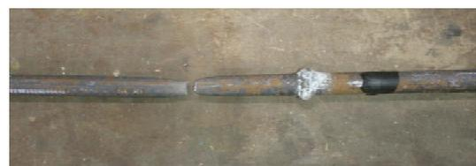
写真2 主筋の最終破断状況
