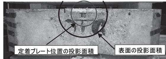
写真4 掃出し破壊の破壊面と有効投影面積
