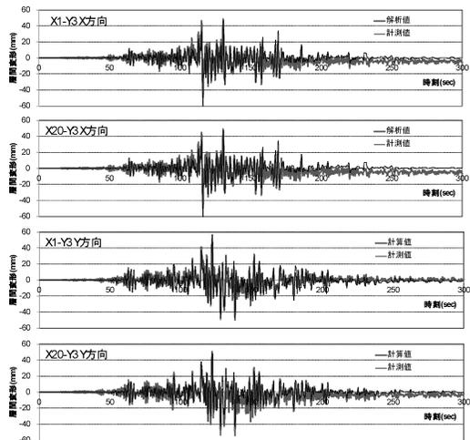
図 15 解析と実測の応答変位の比較
