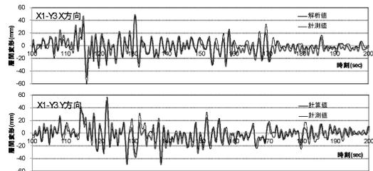
図 16 解析と実測の応答変位の比較(主要動部分)
