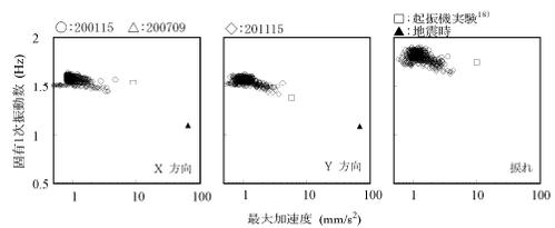
図 27 応答加速度と固有振動数の関係
