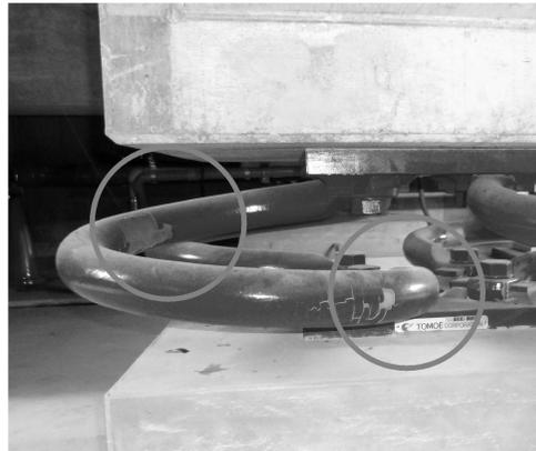
写真 3 鋼棒ダンパーの状況
