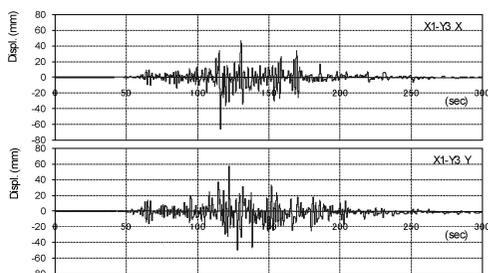
図9 X1-Y3の免震層の相対変位記録(X,Y)
