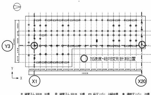
図2 免震層の平面方向の地震観測位置
