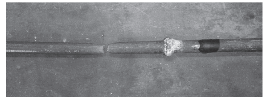
写真2 主筋の最終破断状況 (22φ#3)
